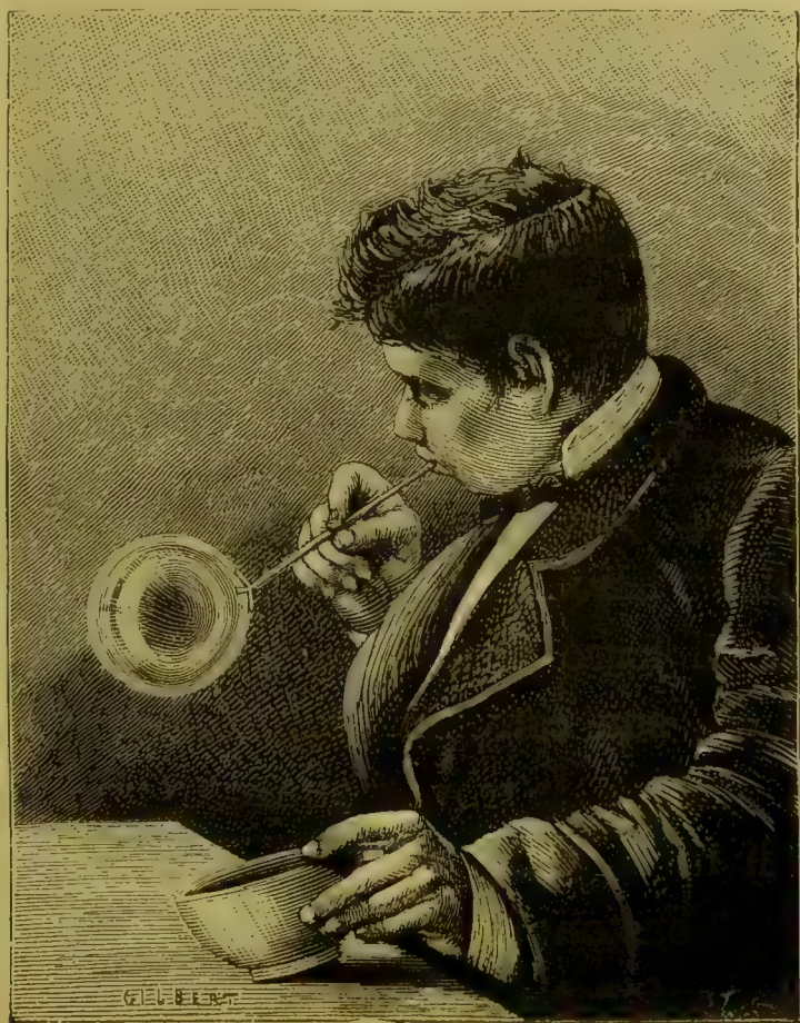
Fig. 125. Bolla di sapone formata all'estremità di un cannello di paglia. Fenomeno degli anelli colorati.
